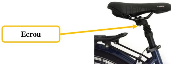
Régler l'inclinaison de la selle, afin d'obtenir la position la mieux adaptée à votre confort. Resserrer l'écrou.
